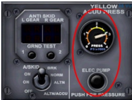
Bild 13: Anzeige des Speicherdrucks im gelben Kreislauf
