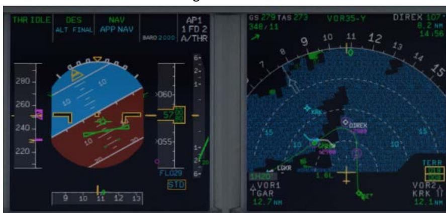
Bild 105: Deceleration Point - Punkt für Reduzierung der Geschwindigkeit
