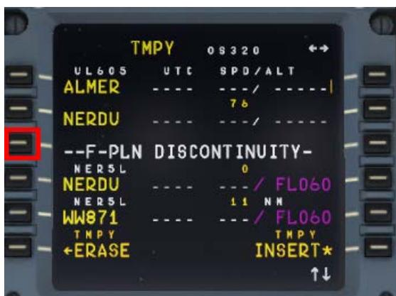
Bild 133: Vorübergehender Flugplan nach dem Zusammenführen mit ALT RTE
