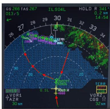
Bild 81: ND – Nach Aktivierung des Flugpfads für einen neuen Versuch
