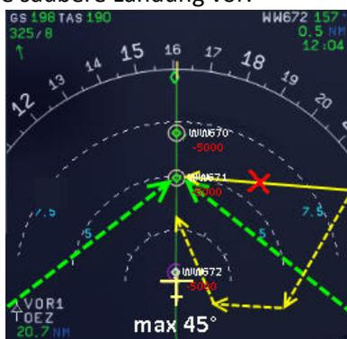
Bild 145: Winkel zum „Einfangen“ eines Gleitpfades
