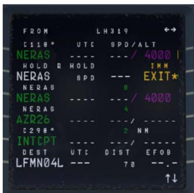
Bild 79: Nach dem Löschen der F-PLAN DISCONTINUITY
