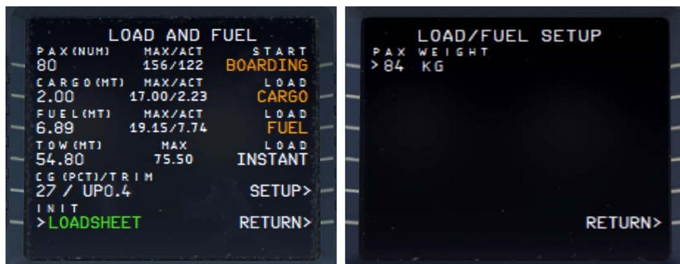
Bild 46: Load/Fuel Menu nach INIT LOADSHEET
