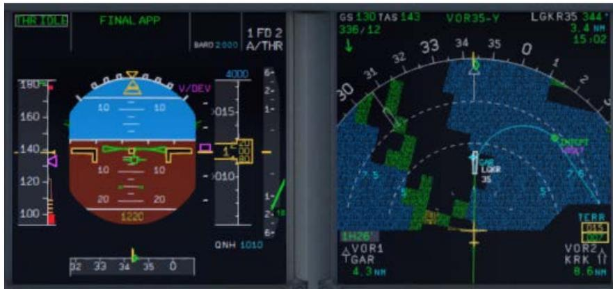
Bild 110: Manueller Anflug nach dem Passieren von MDA (ND = ARC Modus)
