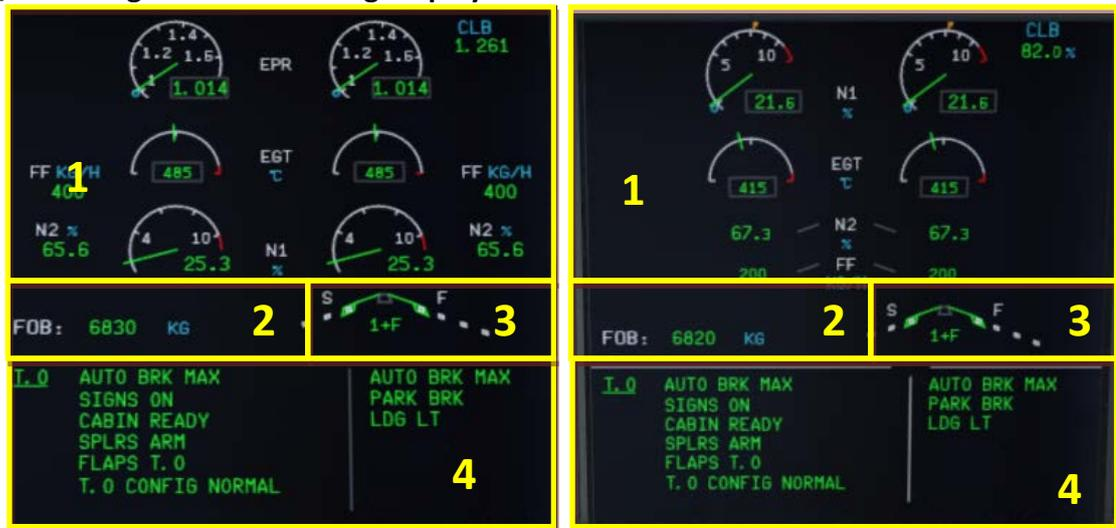
Bild 17: E/WD – Engine Warning Display mit IAE ----- und Flugzeug mit CFM Triebwerken
