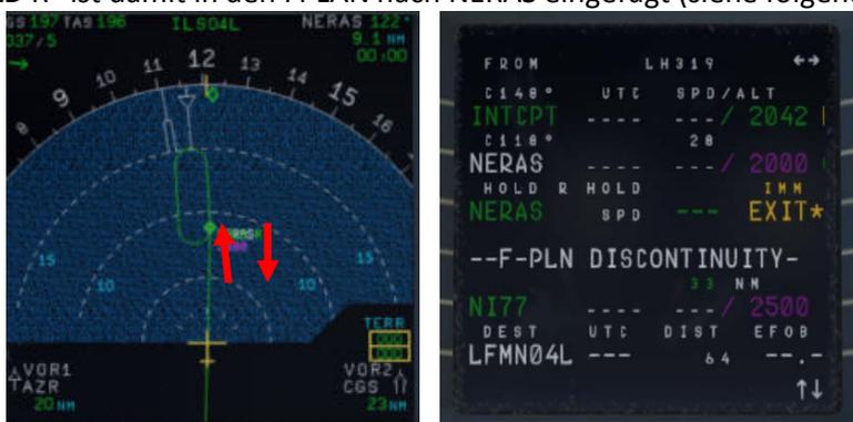
Bild 77: ND – Nach dem Einfügen eines Holdings bei NERAS
