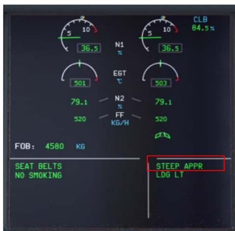
Bild 115: UPPER ECAM – Steep Approach Knopf = ON
