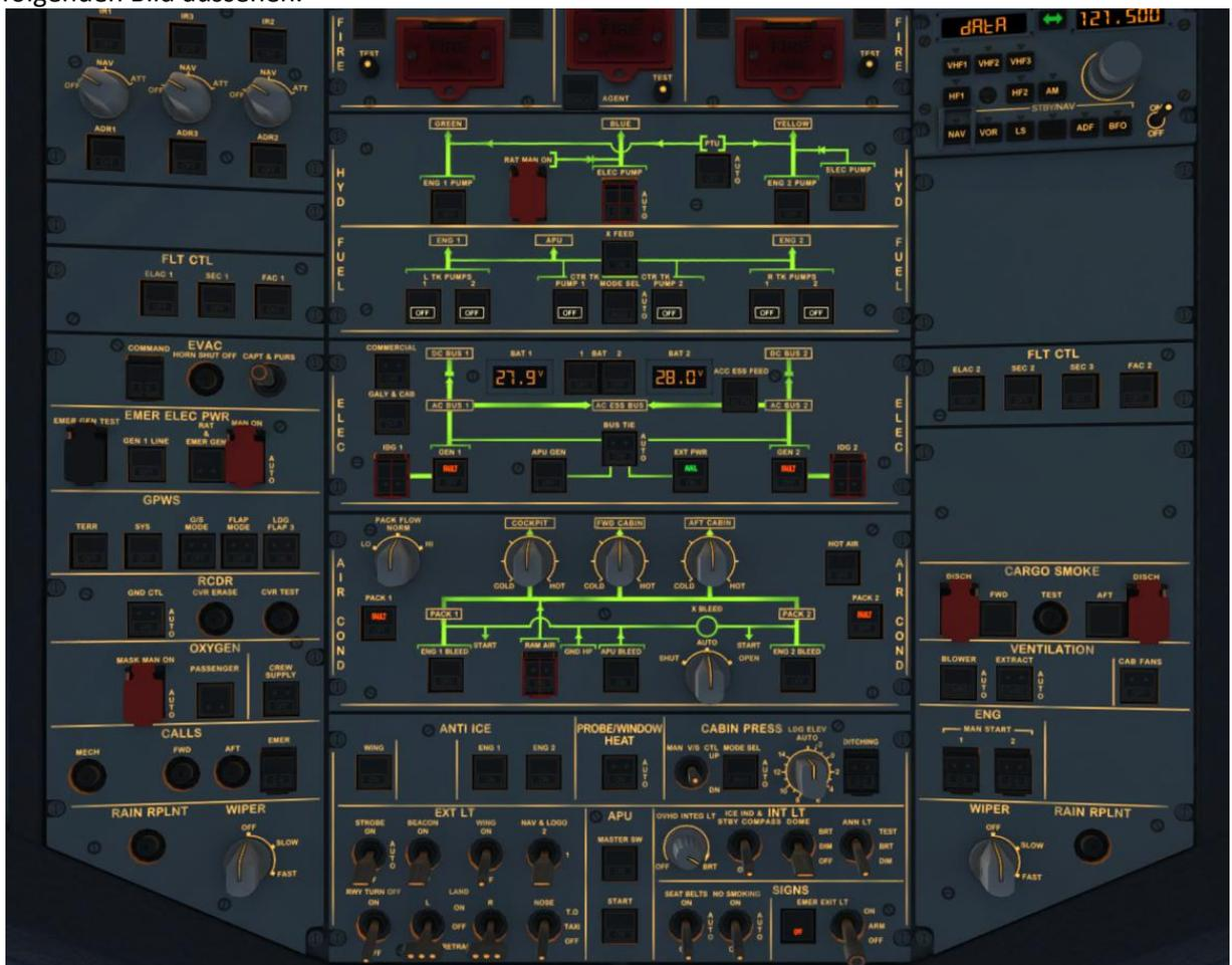
Bild 82: Overhead Panel vor dem Ausschalten der beiden Batterien
