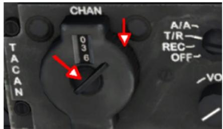
Den Kanal wählen Sie mit dem Drehknopf vorne und dem größeren Drehknopf der hinter der Frontplatte sitzt. Spots zum Anklicken der Drehschalter befinden sich links und rechts neben den Instrumenten. Der kleinere Drehknopf dient auch dem ein- und ausschalten des Empfängers. In allen Schalterstellungen außer OFF ist das Gerät empfangsbereit. Mit der Lautstärkeregelung können Sie die Lautstärke des Morsecodes zur Stationsidentifizierung einstellen.
