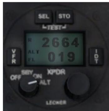
Wenn der Drehschalter auf ALT steht, sendet der Transponder auch die Höhenangaben wenn diese von anderen TCAS Systeme abgefragt werden. Dann wird auch die aktuelle Flughöhe in FL x 100 angezeigt. Dabei bezieht sich der Transponder aber immer auf ISA Bedingungen (1013 mb/ 1013,2 hpa).
