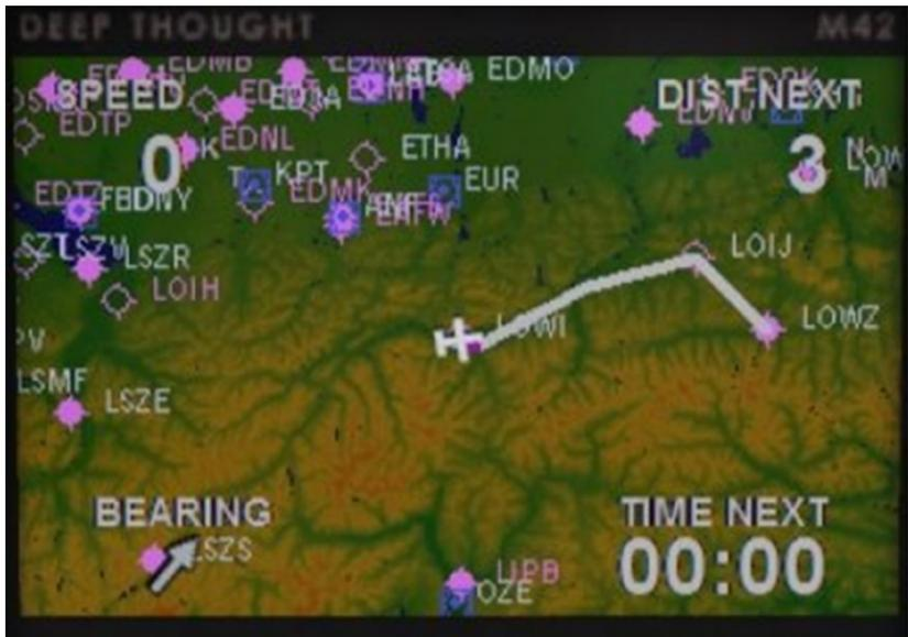
Nach dem Hochfahren zeigt das GPS den Mapmode mit einem Flugzeugsymbol in der Mitte. Norden ist immer oben. In den 4 Displayecken werden folgende Werte angezeigt: Geschwindigkeit über Grund, Entfernung zum nächsten Waypoint, Flugzeit zum nächsten Waypoint und ein Pfeil der in Richtung der nächsten Waypoints zeigt.
