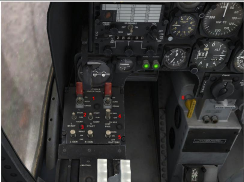
1. Schalter für Dauerzündung und Segelstellung der Propeller
